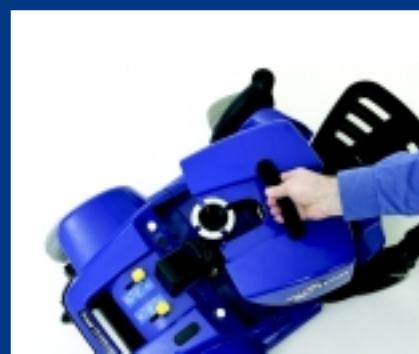
Pacco batterie di facile rimozione, senza collegamenti di cavi
